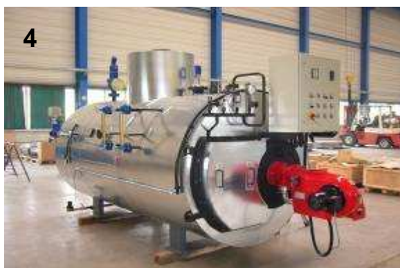
4 Паровй котёл низкого давления, Кинчаза / Конго
