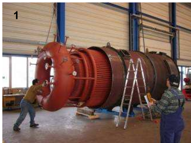
1 Паровой котёл высокого давления, типа HPB 3,5 т/ч 80 бар для Малайзии
