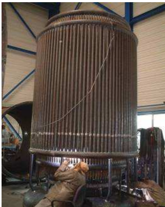
1 Паровой котёл высокого давления, типа HPB 3,5 т/ч 80 бар для Малайзии
